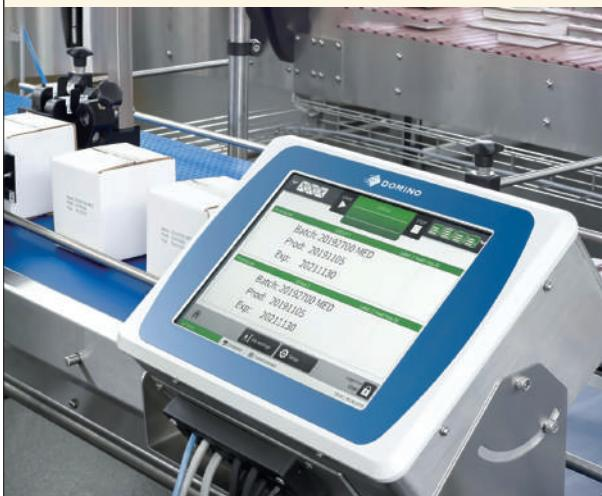
プリンターの機構を内蔵し、モニターも兼ねる軽量なデザインは、何種類もの工法を考案した結果、継ぎ目や溝の少ない設計が採用された。
