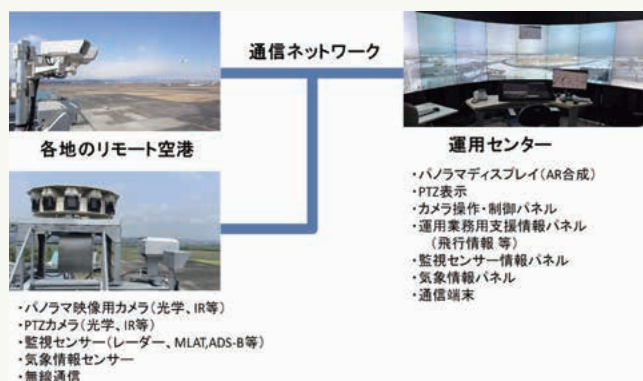
図1. RT・DTのシステム構成概要
