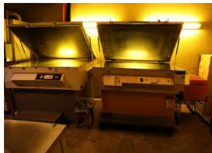
リトグラフPS版、銅版画の写真製版などの感光作業を行う場所。かつてここに版画研究室があった、いわばグラフィックアーツ専攻スタートの地でもある
